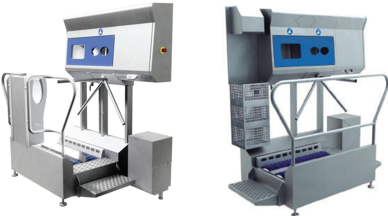
Entrata igienica completa di lavaggio, asciugatura e disinfezione mani. Inizialmente vi è un processo di lavaggio mani e asciugatura e poi, durante la fase di disinfezione delle mani tramite nebulizzazione del disinfettante (regolabile) avviene il lavaggio delle suole tramite spazzole. La barriera automatica si apre dopo un tempo impostato dall'inserimento delle mani nei cilindri, mentre risulta libero nella direzione opposta.
